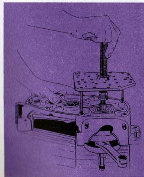
Obr. 31: Vylisování klikového mechanismu
